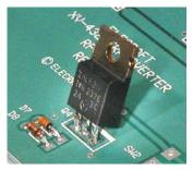
Figure 22. Installing Transistor Q4.
