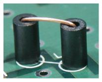
Figure 20. Installing L7.
